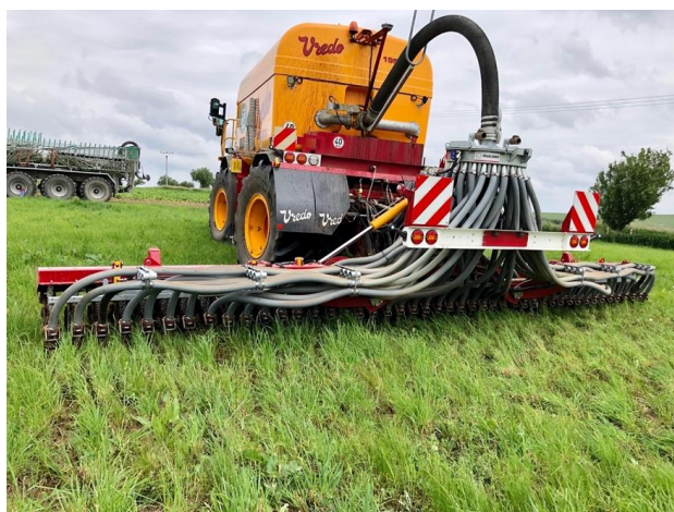
Obr.1: Aplikace samojízdným aplikátorem vybaveným travním injektorem
